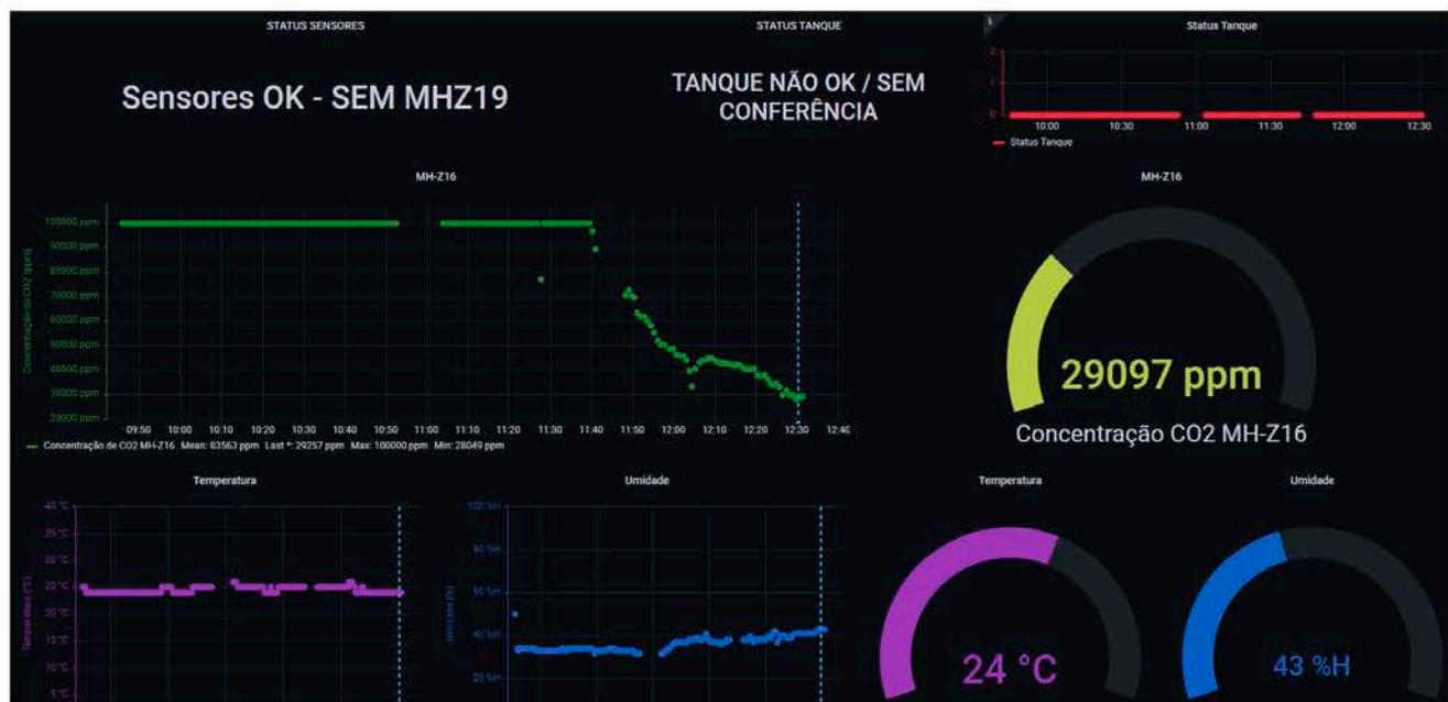
Figura 24: Página do Grafana mostrando um teste de medição utilizando o sensor MH-Z16 com gráficos e valores atuais de concentração de CO<sub>2</sub> (em ppm), temperatura, umidade e texto do status dos sensores e da conferência do tanque
