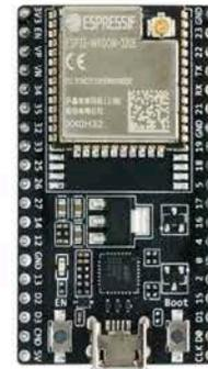
Figura 14: Módulo ESP32 WROOM 32UE utilizado no projeto [19]
