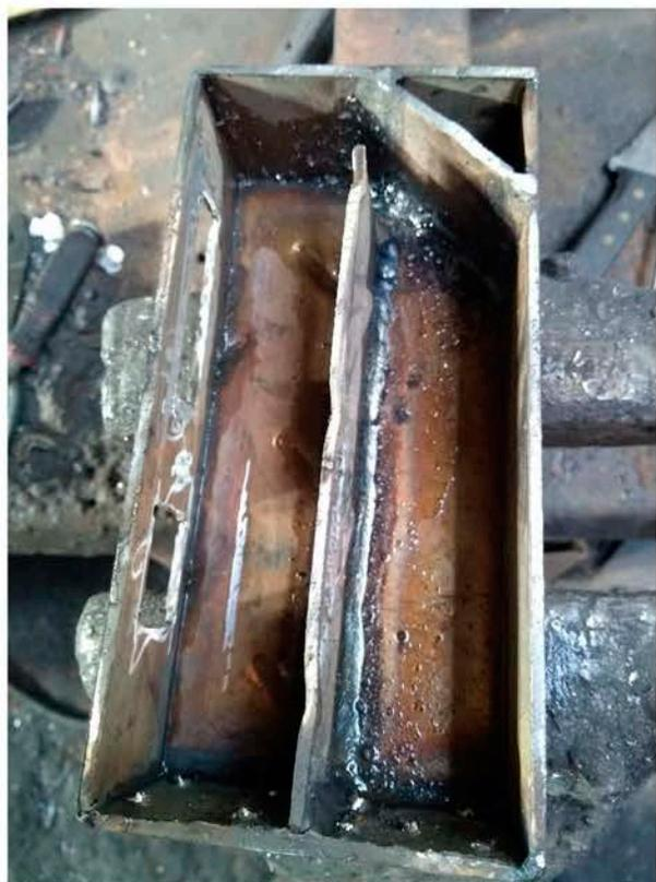
Figura 19: Câmara de inox utilizada no início do projeto
