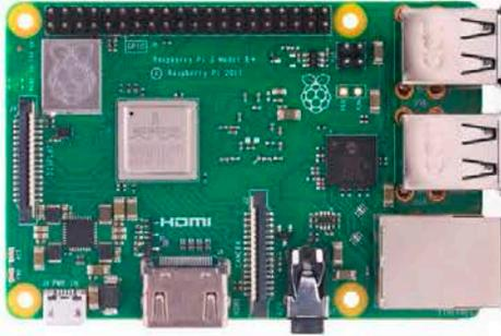
Figura 15: Raspberry Pi 3 Model B+ utilizado no projeto como servidor local com comunicação com a internet [20]
