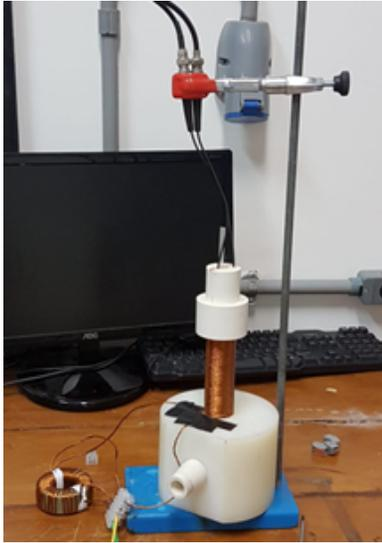
Figura 2.11: Sistema de detecção dentro da bobina de campo e conectados aos canais do osciloscópio.
