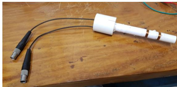
Figura 2.10: Bobina sensora de campo e gradiômetro.
