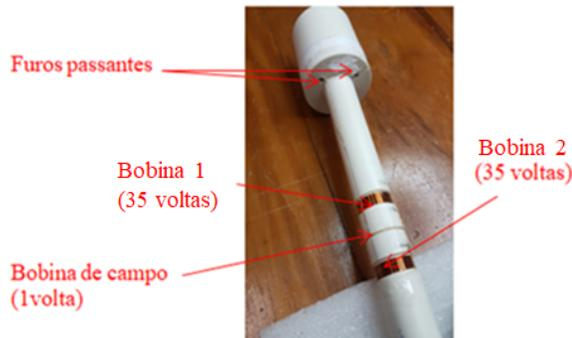
Figura 2.9: Bobina sensora de campo (1 volta) e gradiômetro (bobinas 1 e 2 com 35 voltas) enrolados no suporte de PVC.
