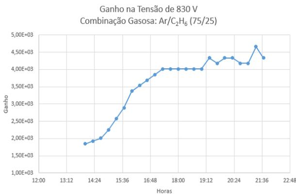
Figure 18: Variação do ganho usando um pré-amplificador de carga, durante oito horas, para a mistura gasosa Ar/C<sub>2</sub>H<sub>6</sub> (75/25).
