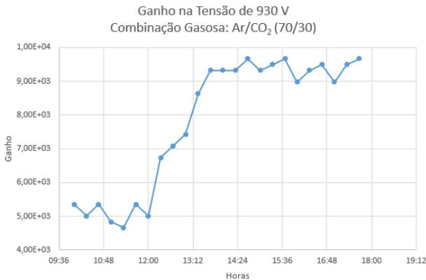
Figure 17: Figura 17. Variação do ganho usando um pré-amplificador de carga, durante oito horas, para a mistura gasosa Ar/CO<sub>2</sub> (70/30).
