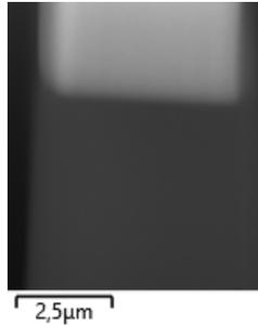
Figura 5: Imagem obtida com feixe de elétrons (30 kV e detector de elétrons retroespalhados) da face transversal (perpendicular à superfície da amostra) construída na amostra de Si. A região superior clara é a Pt. Regiões laterais escuras são a trincheira.
