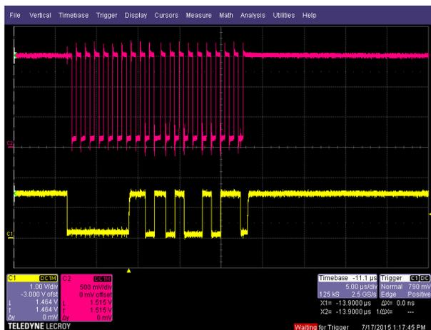
Figura 13: Exemplo de operação de leitura no barramento I<sup>2</sup>C medidos, operando na frequência de 1 MHz, no osciloscópio LeCroy 44MXs-B.
